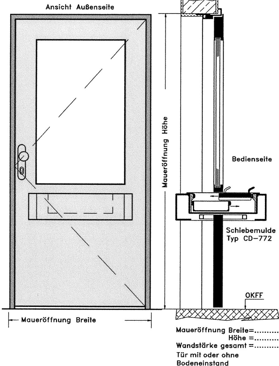
Die Schaltertür mit integriertem Schalterfenster ist als Schalterabschluss für einen Kassenraum konzipiert. Durchbruch- und Durchschusshemmung entsprechen der Vorgabe nach UVV-Kassen. Die Panzerglasqualität entspricht P7B/BR3 nach DIN-EN.
