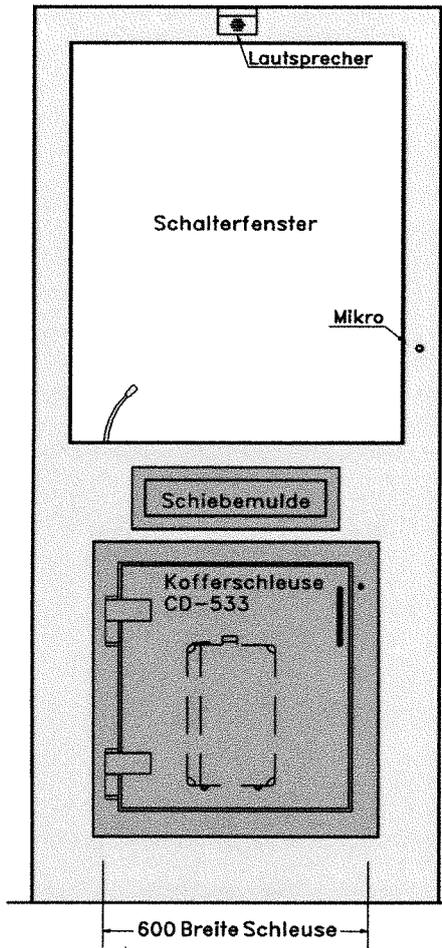
Die Zusammenstellung dieses Elementes für den Einbau in eine bauseitige Wandöffnung zeigt als Beispiel einen zur Besucherseite ca. wandbündigen Schalter. Die Wandanschlüsse können den bauseitigen Gegebenheiten angepasst werden. Außerdem sind die Stellung des Schalters in einer Trennwand, die Modellauswahl einer Schiebemulde, evtl. Sonderfunktionen oder die Farbwahl des Elementes Vorgaben, die wir in eine montagefertige Maßanfertigung übernehmen.
