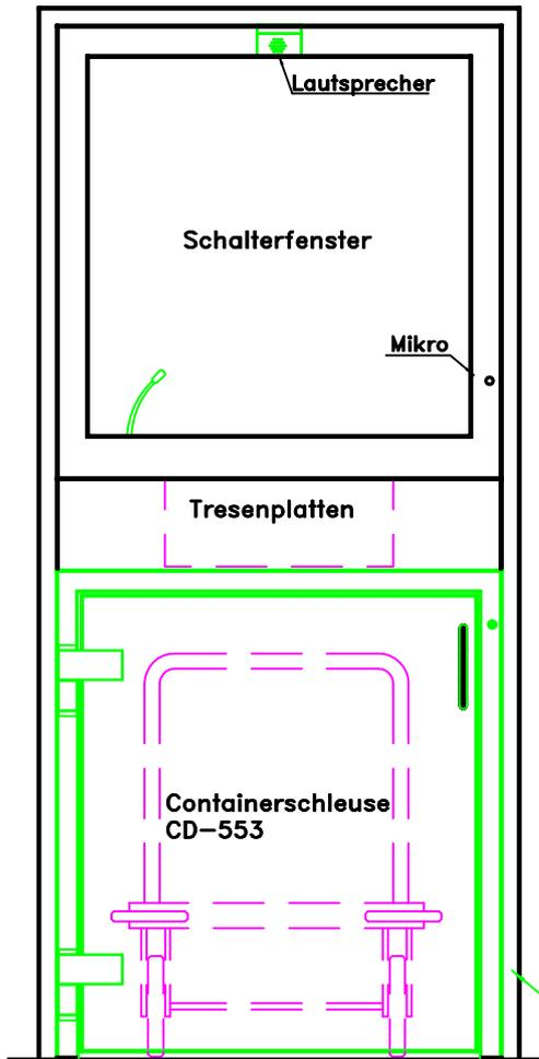
Die konstruktive Zusammenstellung dieses Elementes für den Einbau in eine bauseitige Wandöffnung ist als Beispiel zu verstehen. Es sind verschiedene Kombinationen möglich. Die Wandanschlüsse können den bauseitigen Gegebenheiten angepasst werden. Die Stellung der Schleuse, die Modellauswahl der Schiebemulde mit passendem Ablagetresen oder die Farbauswahl sind Vorgaben einer montagefertigen Maanfertigung.
