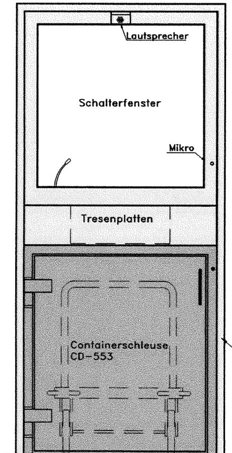
Die konstruktive Zusammenstellung eines Elementes für den Einbau in eine bauseitige Wandöffnung ist wie abgebildet nur als Beispiel zu verstehen. Die Wandanschlüsse können den bauseitigen Gegebenheiten angepasst werden, die Stellung der Containerschleuse, die Modellauswahl einer Belegdurchgabe als Schiebemulde mit passender Ablagetresenplatte oder die Farbwahl nach RAL sind Vorgaben einer montagefertigen Maßanfertigung.
