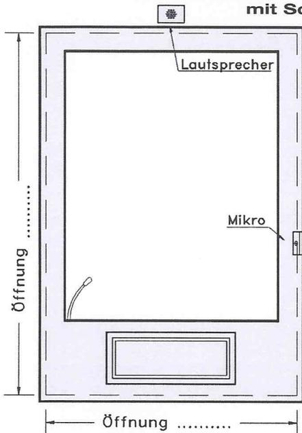
Das Schalterfenster ist eine Maßanfertigung mit der Kundenvorgabe zur Größe, zum Einsatz als Außen- oder Innenschalter, zu den Einbaualternativen und zur gewünschten Farbgestaltung. Wir liefern montagefertige Schalter mit Rahmen, Frontblenden, sowie mit Panzerglas und Schiebemulde als Standardausführung – hier Typ CD-743-BS/F30-FB4. Die komplette Ein-
