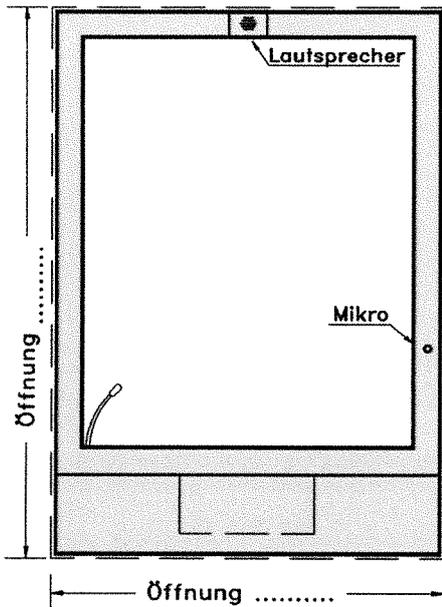
Schalterfenster sind Maßanfertigungen mit Kundenvorgabe zur Größe, Funktion, Einbaualternativen und zur Farbgestaltung. Wir liefern montagefertige Elemente mit Rahmen, Panzerglas, Tragkonstruktion für die Schiebemulde und Bekleidungen als Tresenteile sowie die Durchgabeschiebemulde.
