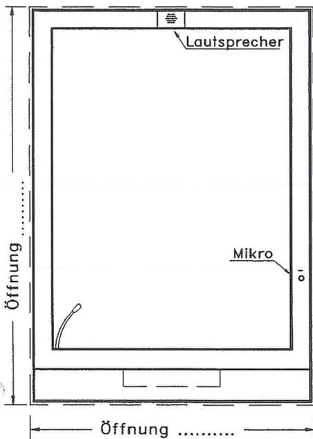
Schalterfenster sind Maßanfertigungen mit Kundenvorgabe zur Größe, Funktion, Einbaualternativen und zur Farbgestaltung. Wir liefern montagefertige Elemente mit Rahmen, Panzerglas, Tragkonstruktion für die Schiebemulde und Bekleidungen als Tresenteile sowie die Durchgabemulde.
