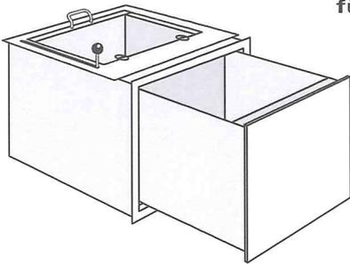
Schiebemulde als Durchgabe für den Einbau unter einer Schalterverglasung eines Außenwand-/Trennwand-schalterfensters mit außenwandbündigem Anschluß.
