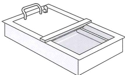
Schiebemulde als Durchgabe für den Einbau unter einer Schalterverglasung mit Rahmen nach FB4 in einer Ablage, Bekleidung oder beidseitigen Tresenkörper.
