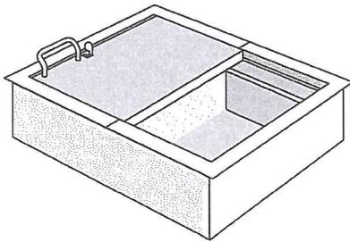
Schiebemulde als Durchgabe für den Einbau unter einer Schalterverglasung in eine Ablage, Bekleidung oder beidseitigen Tresenkörper. In der Ausführung wie Typ CD-770,
