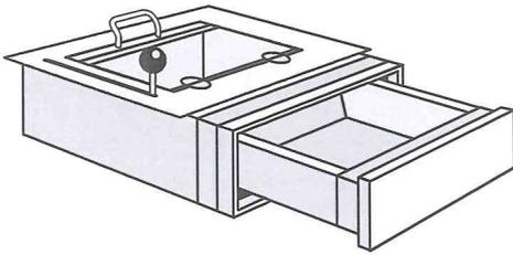
Schiebemulde als Durchgabe für den Einbau unter einer Schalterverglasung eines Außenwand-/Trennwand-schalterfensters mit Rahmen nach FB6 und Brandschutz-
