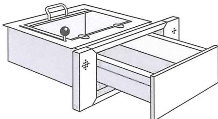
Schiebemulde als Durchgabe für den Einbau unter einer Schalterverglasung eines Außenwand-/Trennwand-schalterfensters mit Rahmen nach FB4 und außenwand-
