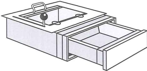
Schiebemulde als Durchgabe für den Einbau unter einer Schalterverglasung eines Außenwand-/Trennwand-schalterfensters mit Rahmen nach FB4 und Brandschutz-
