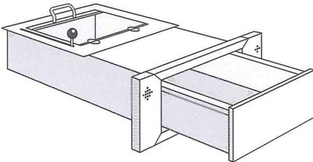
Schiebemulde als Durchgabe für den Einbau unter einer Schalterverglasung eines Außenwand-/Trennwand-schalterfensters mit Rahmen nach FB4 und außenwand-
