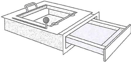
Schiebemulde als Durchgabe für den Einbau unter der Schalterverglasung eines Außenwand-/Trennwandschalterfensters mit außenwandbündigem Anschluss. Das Gerät
