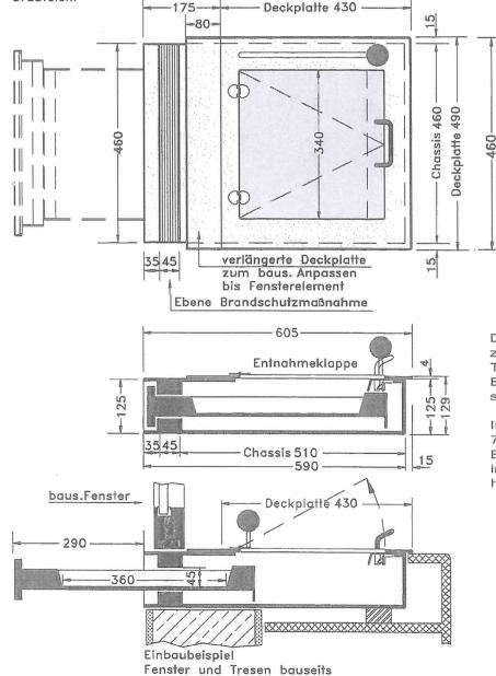
Das Gerätechassis ist innen zu unterstützen bzw. in einem Tresen zu befestigen. Eine Demontage des Gerätes sollte möglich bleiben.
