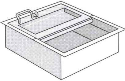
Schiebemulde als Durchgabe für den Einbau unter einer Schalterverglasung in eine Ablage, Bekleidung oder beidseitigen Tresenkörper in kleinerer Ausführung zu Typ
