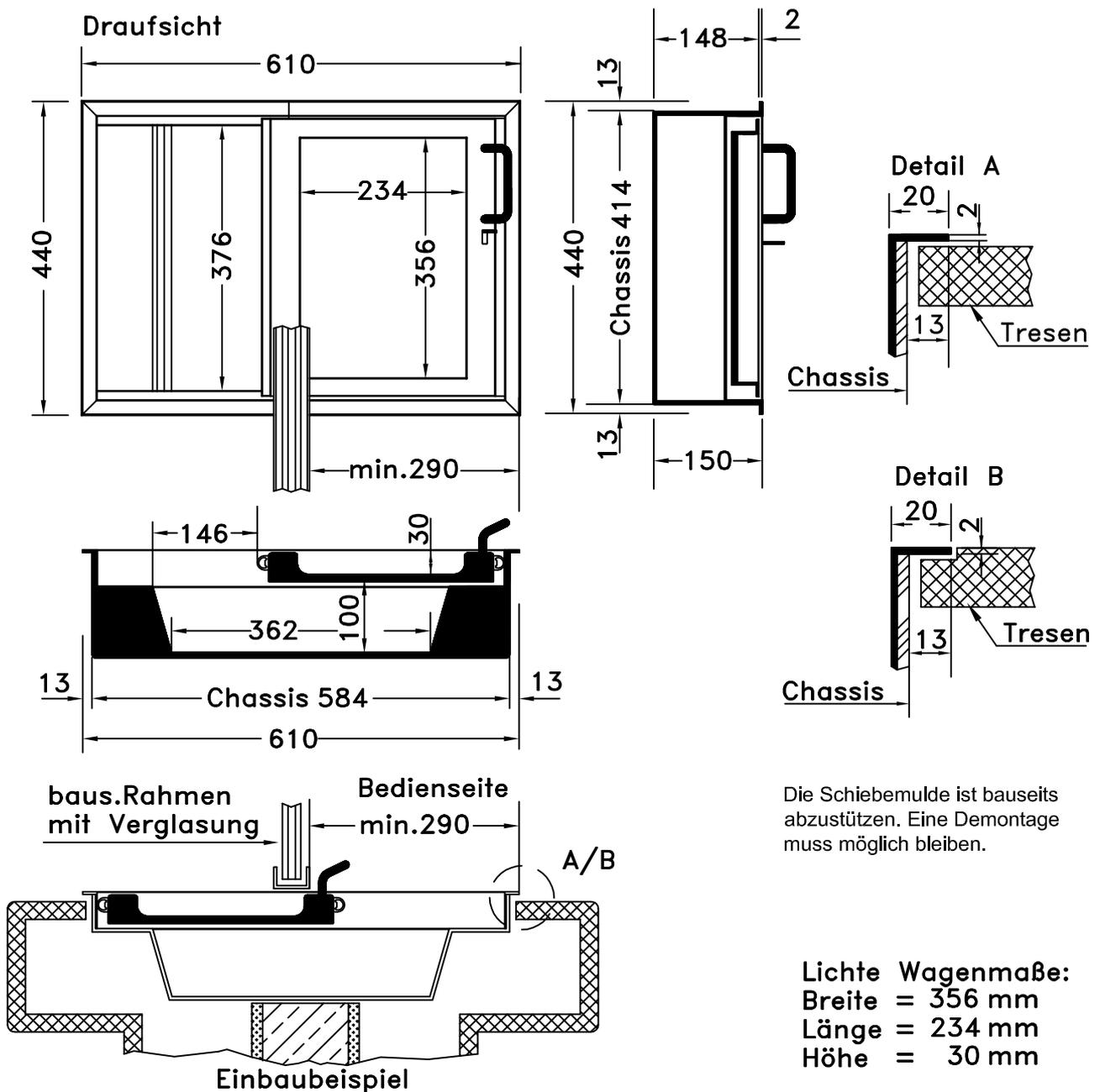
Die Schiebemulde ist bauseits abzustützen. Eine Demontage muss möglich bleiben.
