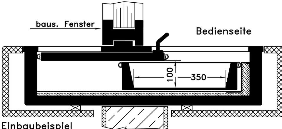
Die Schiebemulde ist bauseits abzustützen. Eine Demontage der Schiebemulde muss möglich bleiben.
