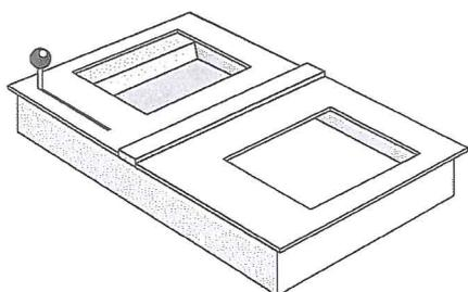
Ausführung zum Typ CD-714-FB6 ist besonders geeignet für den schnellen Schalterverkehr mit Belegen bis DIN A4 ohne Warenaustausch. Für einen Durchgabevorgang wird der, im Chassis unter einer Mittenabdeckung laufende, Muldenwagen über den Stell- und Arretierungshebel bewegt. In den Endstellungen wird der Muldenwagen arretiert und mit dem Stellhebel entriegelt.
