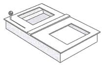
Schiebemulde als Durchgabe für den Einbau unter einer Schalterverglasung mit Rahmen nach FB4 in einer Ablage, Bekleidung oder beidseitigen Tresenkorpus. Für einen Durchgabevorgang wird der, im Chassis unter einer Mittenabdeckung laufende Muldenwagen über den Stell- und Arretierungshebel bewegt. In den Endstellungen wird der Muldenwagen arretiert und mit dem Stellhebel entriegelt.
