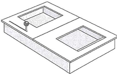
Schiebemulde als Durchgabe für den Einbau unter einer Schalterverglasung in eine Ablage, Bekleidung oder beidseitigen Tresenkörper. Für einen Durchgabevorgang wird
