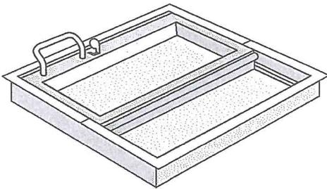
Schiebemulde als Durchgabe für den Einbau unter einer Schalterverglasung in eine Ablage, Bekleidung oder beidseitigen Tresenkörper. Die Schiebemulde wird für den schnell-
